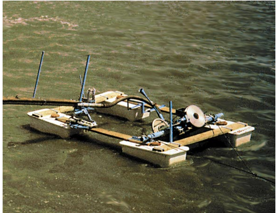
Foto 1: Turbina Garman para bombeo de agua
