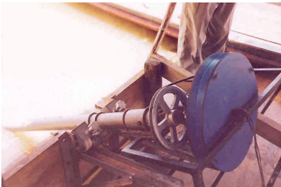
Foto 5: Generador de imanes permanentes
