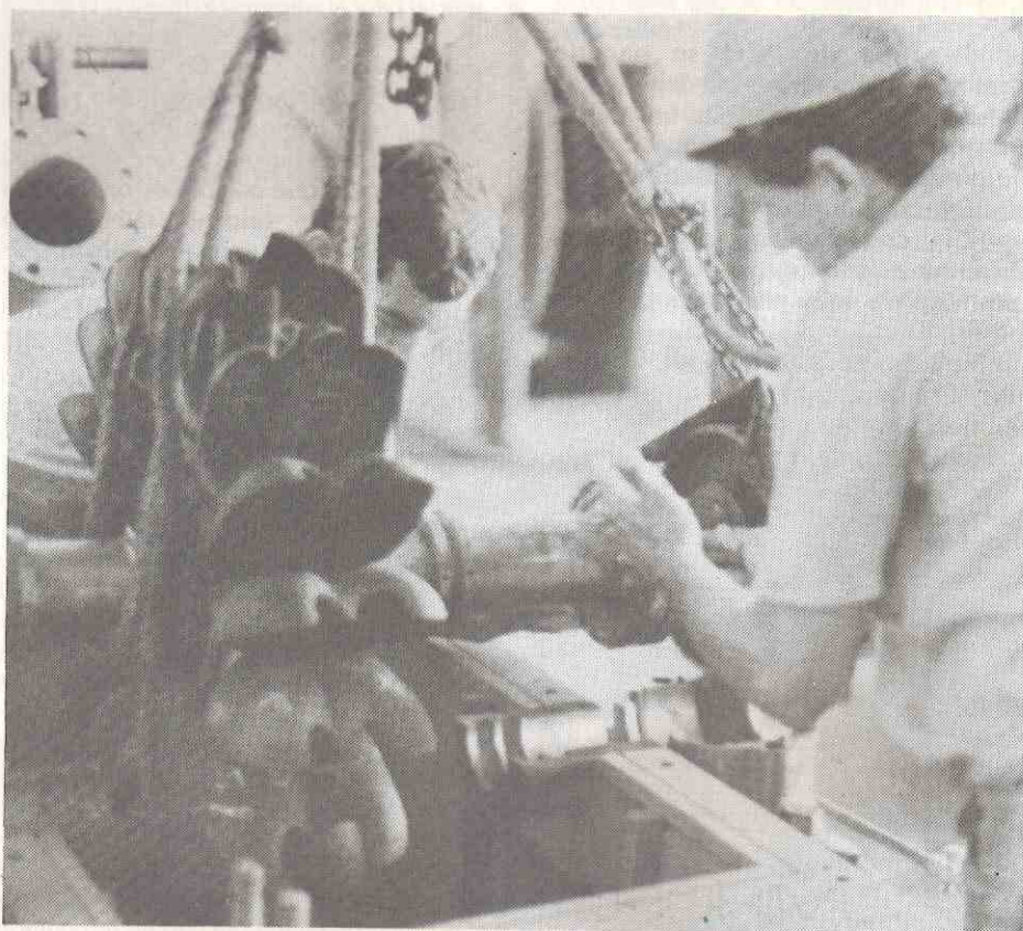
Montando los cojinetes de una turbina Pelton, fabricada en Colombia.
