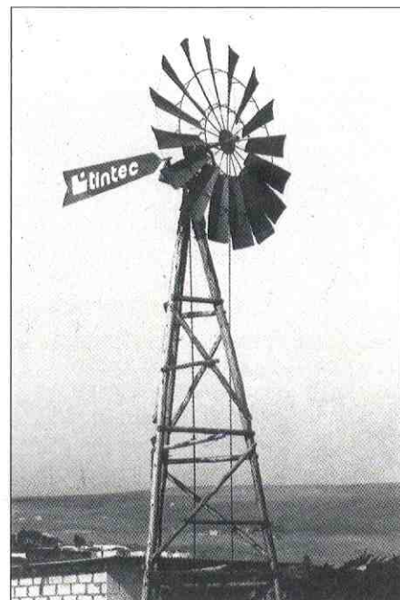
Fig. 2: Molino de eje horizontal de varios números de álabes (ITINTEC)
