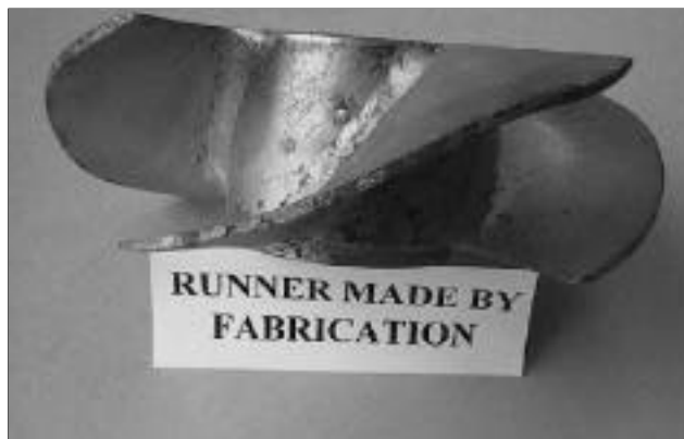
FIG. 3: Prototipo del rodete original
