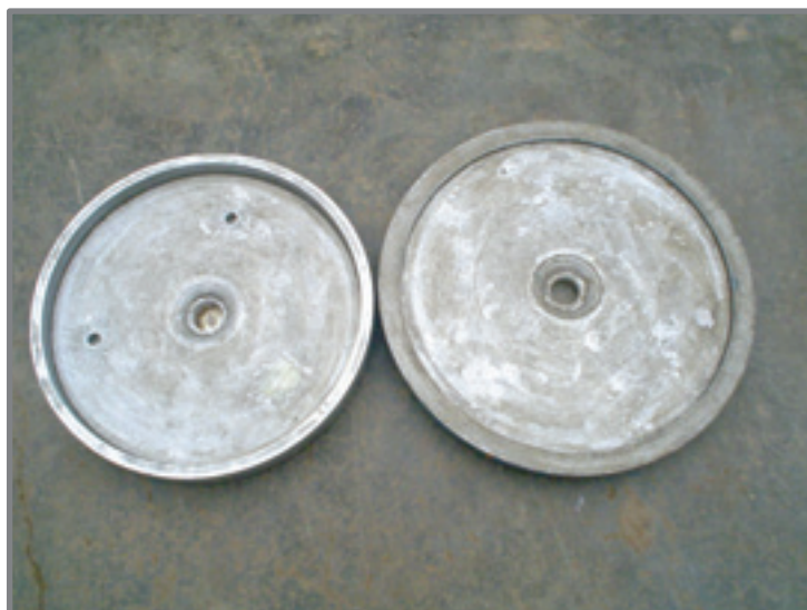
Foto N° 02: Molde de aluminio del estátor Fuente: Soluciones Prácticas – ITDG.
