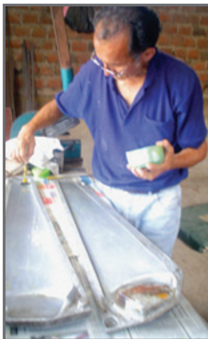
Foto N° 18: Dos partes del molde de aluminio que dan forma a la pala Fuente: Soluciones Prácticas – ITDG.
