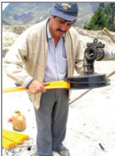
Foto N° 35: Acople de la pala donde la parte más plana es colocada hacia abajo. Fuente: Soluciones Prácticas – ITDG.
