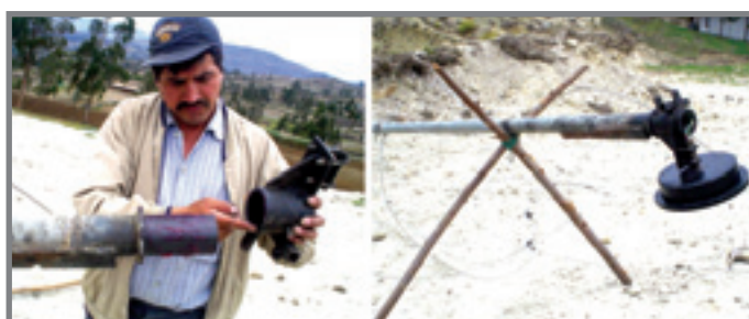
Fotos N° 33 y 34: Bastidor y colocación de grasa (izquierda). Generador sujetado por abrazaderas tipo U (derecha). Fuente: Soluciones Prácticas – ITDG.
