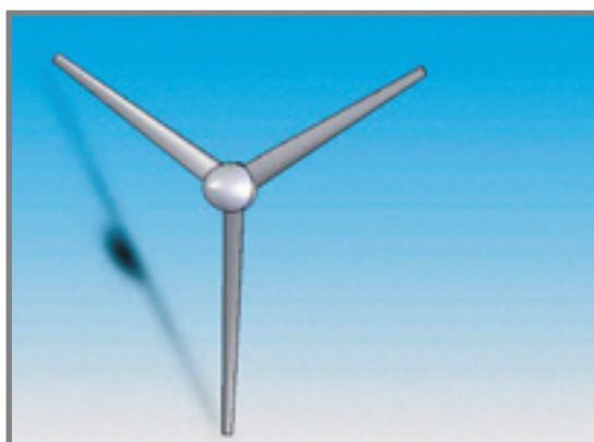
Gráfico N° 22: Rotor eólico de tres aspas Fuente: Soluciones Prácticas – ITDG.
