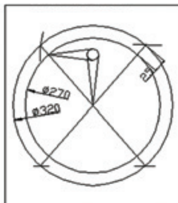
Gráfico N° 13: Medidas del segundo disco. (izquierda) Fuente: Elaboración propia / Soluciones Prácticas- ITDG. Foto N° 04: Anillo con los nueve agujeros. (derecha) Fuente: Soluciones Prácticas – ITDG.
