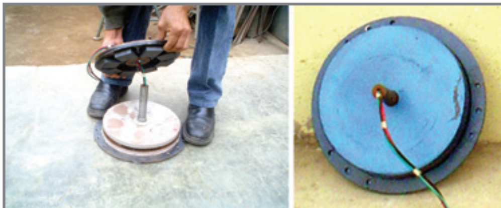
Foto N° 14 y 15: Armado final del generador (izquierda) Generador terminado (derecha) Fuente: Soluciones Prácticas – ITDG.
