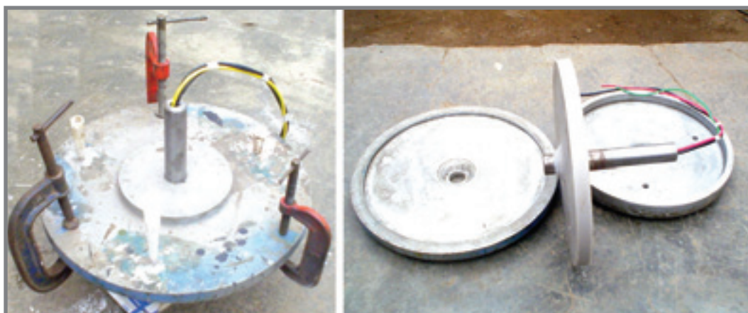
Foto N° 12 y 13: Molde con dos tubos por donde se agrega la mezcla para llenado uniforme (izquierda). Resultado del proceso en una pieza sólida (derecha). Fuente: Soluciones Prácticas – ITDG.
