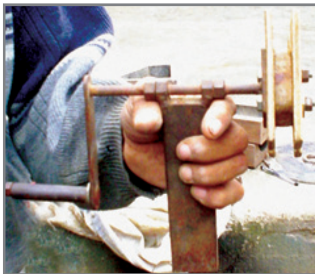
Foto N° 03: Molde de las bobinas armado, listo para construir las bobinas. Fuente: Soluciones Prácticas – ITDG.
