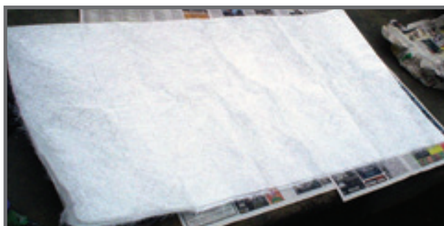
Foto N° 20: Manta de fibra de vidrio. Fuente: Soluciones Prácticas – ITDG.
