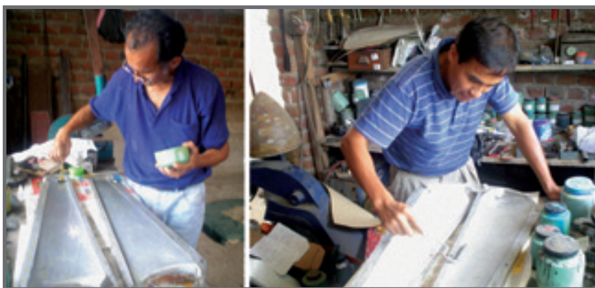
Fotos N° 22 y 23: Aplicación de la primera capa de resina (izquierda). Modo de aplicación de resina para romper burbujas (derecha). Fuente: Soluciones Prácticas – ITDG.
