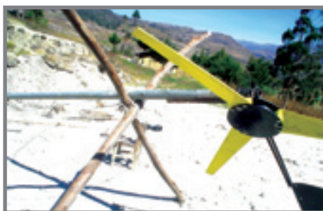
Foto N° 32: Tubo apoyado en dos maderos armados en campos. Fuente: Soluciones Prácticas – ITDG.
